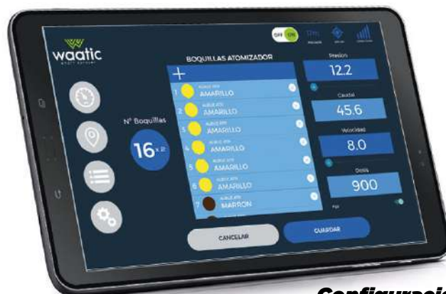
Configuración de las boquillas instaladas
