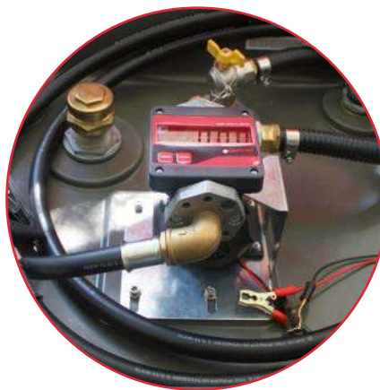
Cuentalitro MGE-110 instalado en moviltank
