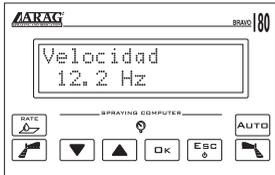
Se visualiza la frecuencia (Hz) detectada en el ingreso del sensor de velocidad.
