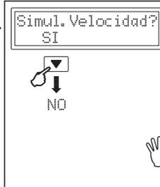
La simulación de la velocidad de avance permite distribuir el producto incluso si falta un detector de velocidad montado en las ruedas.
