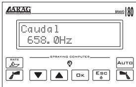
Se visualiza la frecuencia (Hz) detectada en el ingreso del regulador de flujo.
